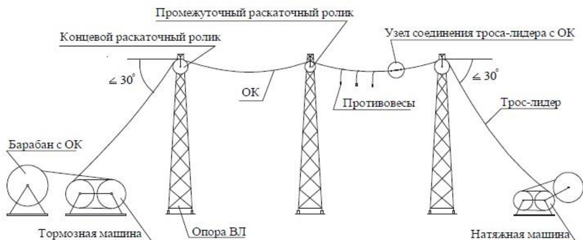
Рис. 3 Схема раскатки ОК
