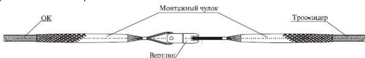
Рис. 2 Схема установки компенсатора кручения (вертлюга)
