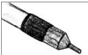
Рис. 4.33. - Загерметизированный колпачок на конце кабеля
